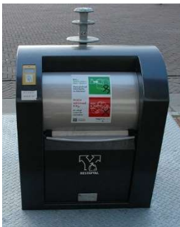
Afbeelding 1a: Ondergrondse verzamelcontainer voor restafval
